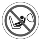
**Let erop dat uw kiddy nooit in voertuigzetels met actieve frontairbag mag worden gebruikt! Een frontairbag die op de babyschaal stuit, kan uw kind zwaar verwonden of zelfs doden!**
