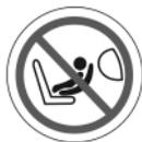
**Prosimy pamiętać, że fotelik kiddy nie może być nigdy montowany na fotelach pasażera z aktywnymi przednimi poduszkami powietrznymi! Przednia poduszka powietrzna, która zostanie wyrzuciona podczas wypadku i uderzy w fotelika zamocowany na przednim siedzeniu może spowodować poważne obrażenia a nawet doprowadzić do śmierci dziecka!**
