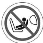
\* Si vous désirez utiliser le système de retenue pour enfant sur le siège passager avant, vous devez désactiver l'airbag ou l'installer sur un autre siège.
